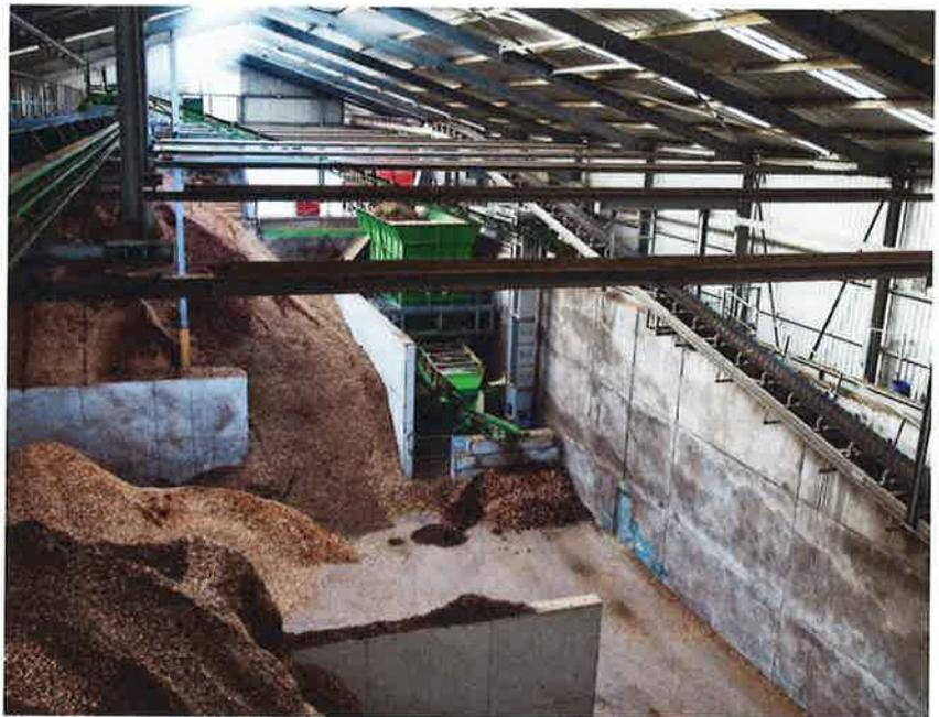
Die Schnitzel fallen über die Mulde direkt in die Siebanlage und werden vom Werkmeister über die Förderanlage zum entsprechenden Sortiment geleitet.
