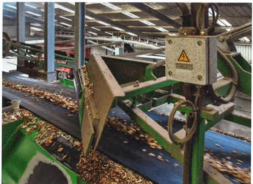
*Die angelieferten Schnitzel werden auf der Förderanlage mit dem Pflugabscheider automatisch qualitätsgetrennt gelagert. Der Preis richtet sich nach der Schnitzelqualität. Eine gute Qualität beginnt bereits im Wald, hängt sie doch von der richtigen Lagerung und Bereitstellung des Energieholzes ab.*
