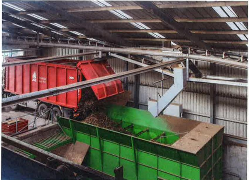
*Eine Schnitzzellieferung wird in der Rehhag-Halle der Lignocalor AG abgeladen.*
