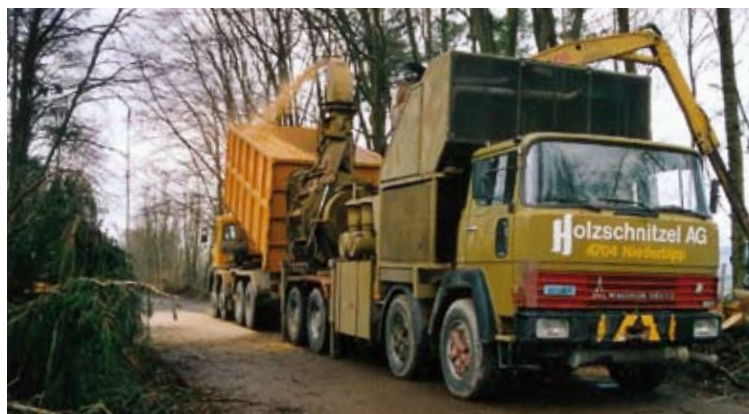
9 Mobiler Holzhaacker im Einsatz
